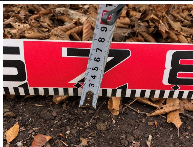
④ モニタリングポイント(洗掘高)
