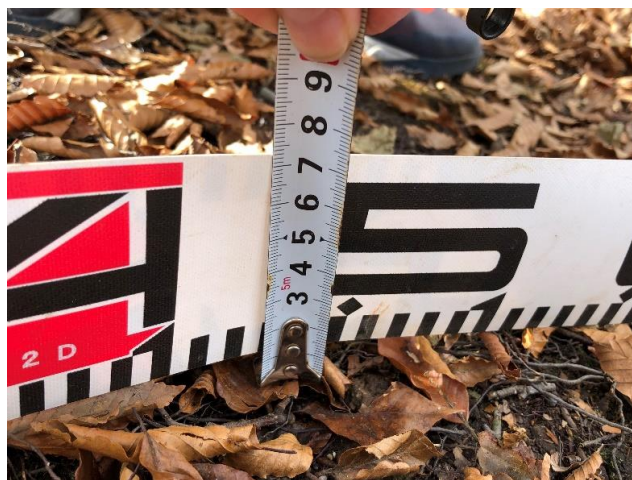
④ モニタリングポイント(洗掘高)
