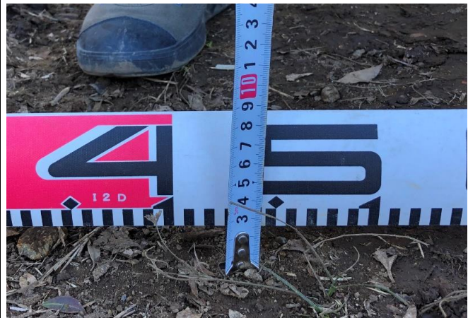
④ モニタリングポイント(洗掘高)
